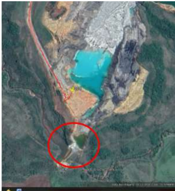
Figura 8. Imagem de satélite corte AFUCAN – na porção oeste um recurso hídrico com barramento, recebendo as drenagens do corte.
